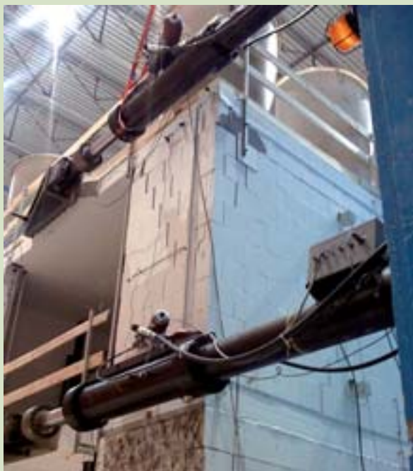
Fig. 14 - Sperimentazione eseguita nei laboratori del JRC: a) modello in scala dell'edificio a due piani in muratura di blocchi in silicato di calcio, con i due bracci meccanici che applicano l'azione orizzontale di piano; b) particolare della fessurazione diagonale, tipico danneggiamento per rottura a taglio di una delle pareti parallele alla direzione di carico.
