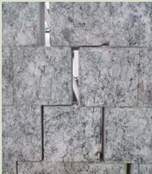
Fig. 14 - Sperimentazione eseguita nei laboratori del JRC: a) modello in scala dell'edificio a due piani in muratura di blocchi in silicato di calcio, con i due bracci meccanici che applicano l'azione orizzontale di piano; b) particolare della fessurazione diagonale, tipico danneggiamento per rottura a taglio di una delle pareti parallele alla direzione di carico.
