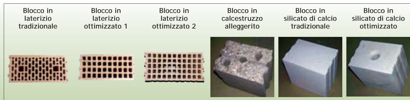
Fig. 16 - Tipologie di blocchi di produzione tedesca.
