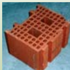
Fig. 15 - Tipologie di blocchi testati dall'Università di Pavia, prodotti dalla azienda italiana RIL.
